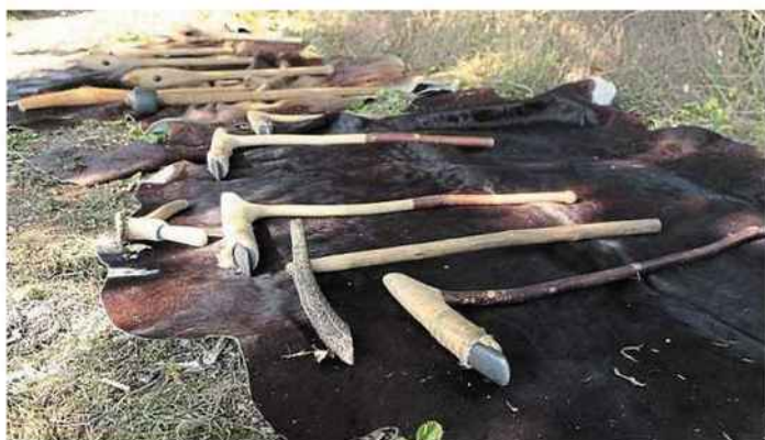
Herminettes et haches utilisées pour creuser la pirogue.
